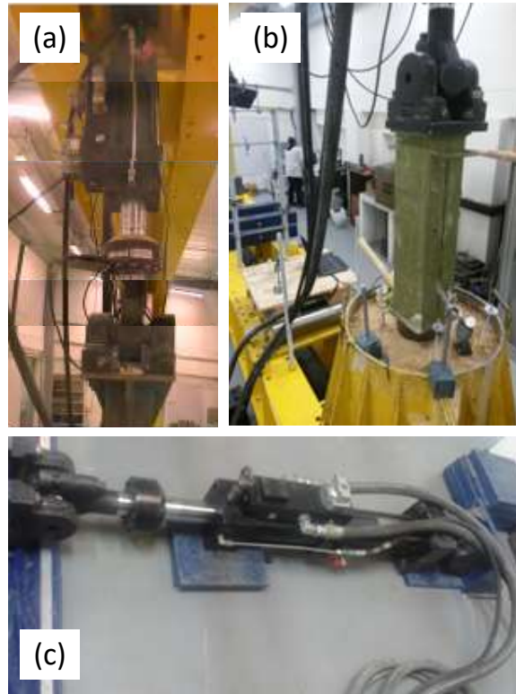
Imagen 5. (a) Actuador dinámico empotrado en el marco metálico del Laboratorio de la PUJ (b) Montaje ensayo Modelo 2. (c) Actuador dinámico. Fuente: Del autor.
