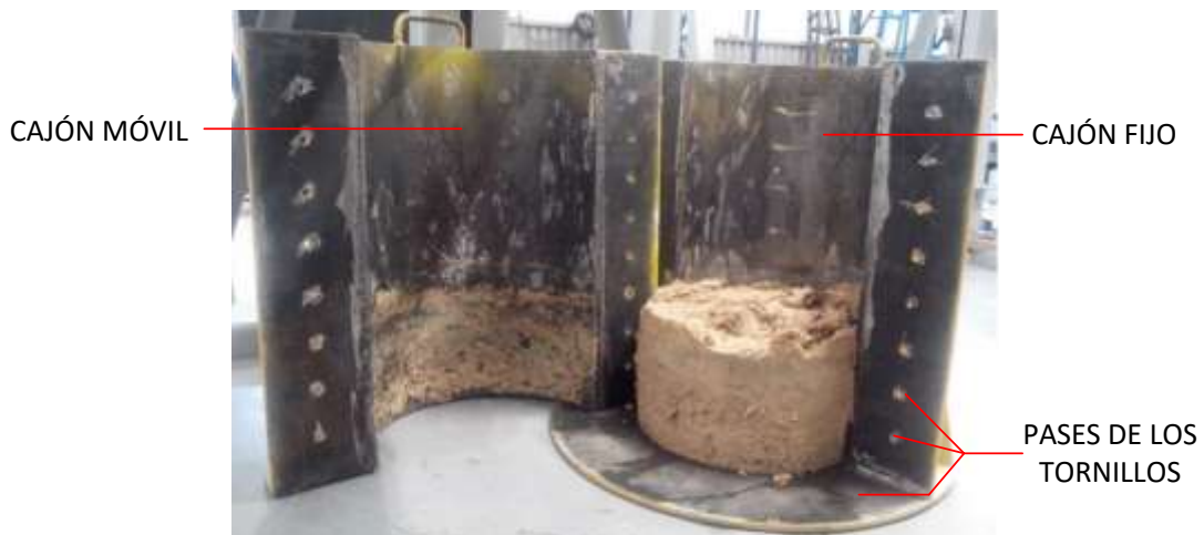
Imagen A1.2. Fotografía caja metálica abierta finalizado el ensayo. Fuente: Propia.
