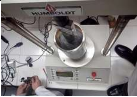
7. Colocar molde en Prensa Marshall
