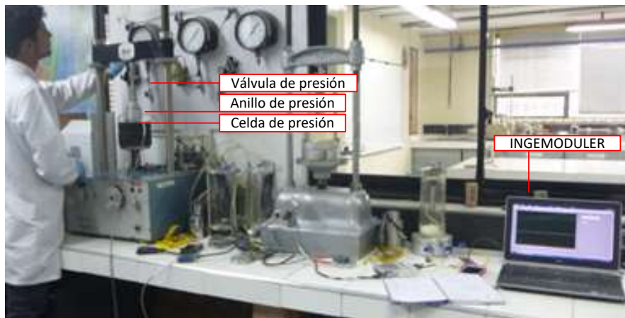
Imagen 3. Procedimiento calibración celdas de presión. Fuente: Propia
