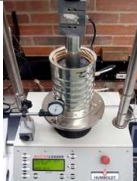
9. Aplicar carga con la prensa Marshall, y medir las deformaciones
