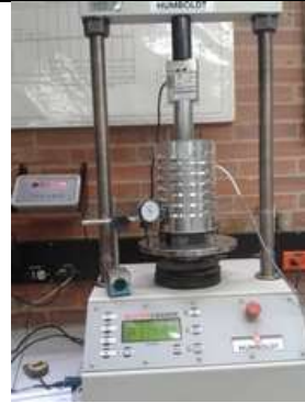
8. Ubicación deformímetro en el plato de la prensa Marshall
