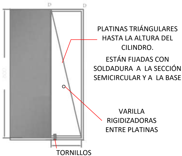
Figura A1.5. Esquema platinas rigidizadoras. Fuente: Propia
