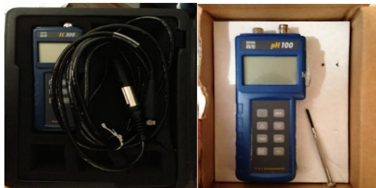
Ilustración 14. Equipos para toma de parámetros de campo. Conductímetro (Izq.) pHmetro (der.)
