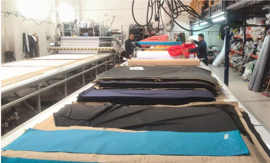
Figura 12 Proceso de Extendido, Confecciones Taller 84
