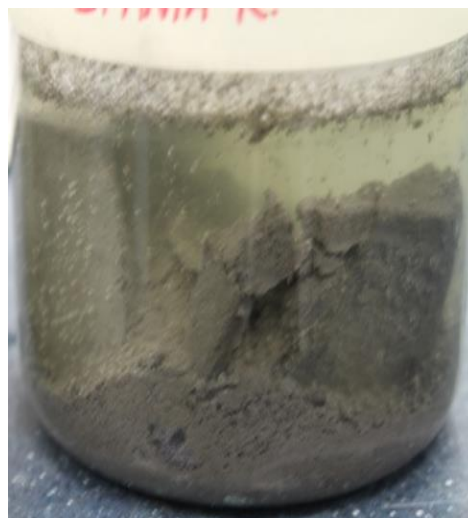
Imagen 27. Mezcla 5 inmersa en Ácido Sulfúrico. Fuente: Elaboración Propia.
