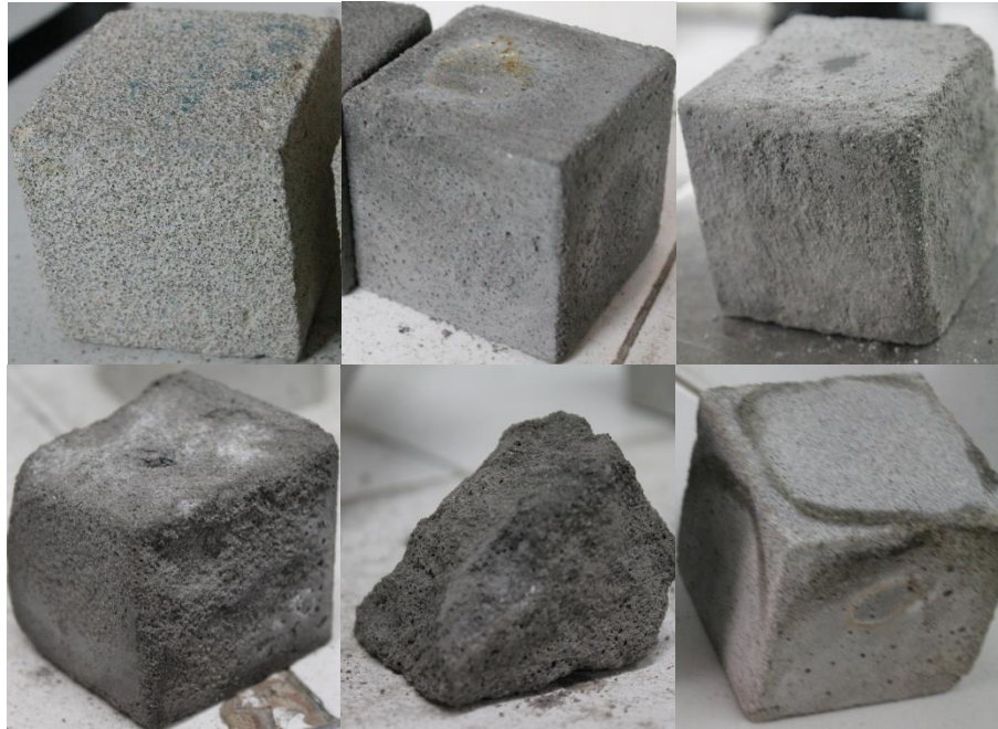
Imagen 28. Pérdida de Masa de Cubos expuestos a ataque de ácidos. a) Mezcla 1 b) Mezcla 2 c) Mezcla 3 d) Mezcla 4 e) Mezcla 5 f) Mezcla 6. Fuente: Elaboración Propia.
