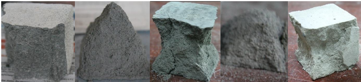
Imagen 29. Falla de Cubos a Compresión expuestos a Ataque de Ácidos. a) Mezcla 1 b) Mezcla 2 c) Mezcla 3 d) Mezcla 4 e) Mezcla 6. Fuente: Elaboración Propia.
