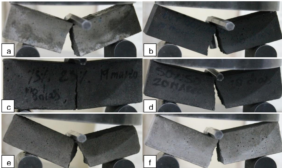
Imagen 19. Falla a Flexión de Viguetas de Mortero. a) Mezcla 1 b) Mezcla 2 c) Mezcla 3 d) Mezcla 4 e) Mezcla 5 f) Mezcla 6. Fuente: Elaboración Propia.
