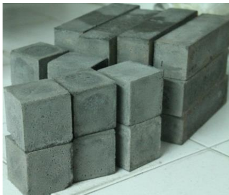
Imagen 7. Cubos y Viguetas de Mortero de Ceniza Volante Activada Alcalinamente. Fuente: Elaboración propia
