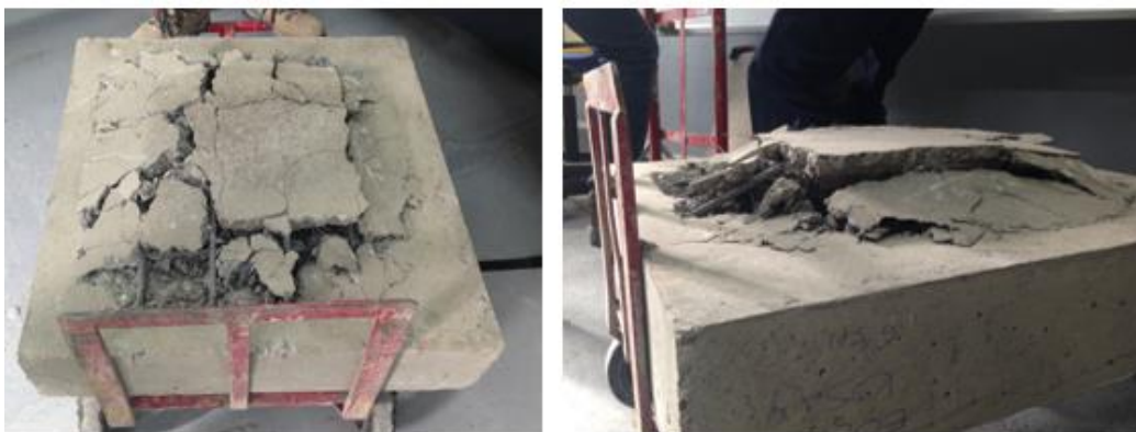
Figura 53. Falla por punzonamiento sistema #3.
