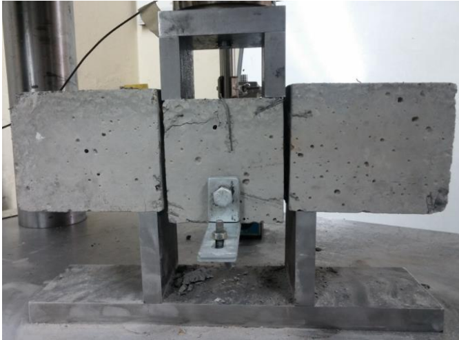
Figura 43. Modo de falla a corte viga con fibra.
