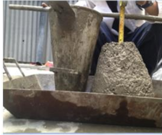
Figura 32. Asentamiento concreto simple
