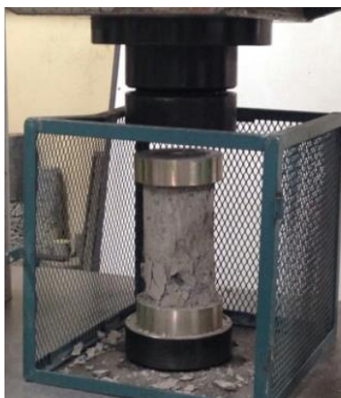
Figura 38. Falla cilindro concreto con fibra.
