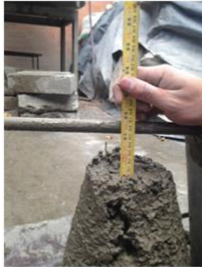
Figura 37. Asentamiento mezcla de concreto para columnas.
