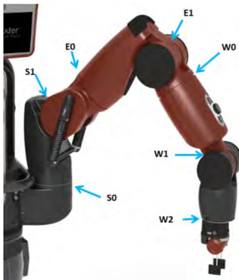
Figura 5.1: Ubicación de los 7 motores representados en ángulos de uno de los brazos del robot Baxter [20]
