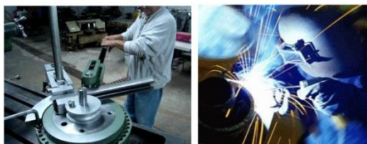
Proceso de doblado y soldado para generar la estructura principal
