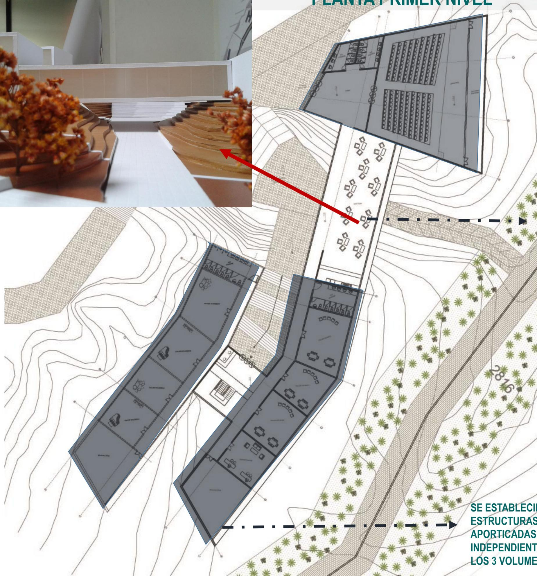
LOS VOLUMENES DE CONEXIÓN SE DEFINIERON COMO ELEMENTOS EN VOLADIZO APOYADOS EN LOS VOLUMENES CONTINUOS, POR MEDIO DE MUROS PORTANTES.
