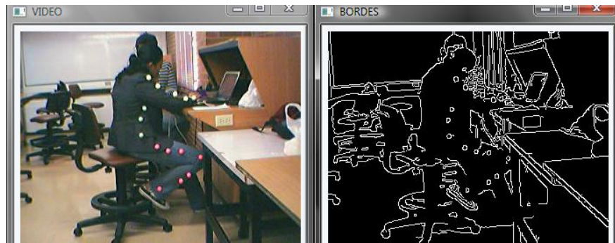
Figura 4. Video original y detección de bordes con filtro Canny
