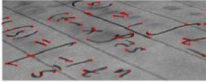
**Figura 5** Ejemplo Detector de esquinas Harris.
