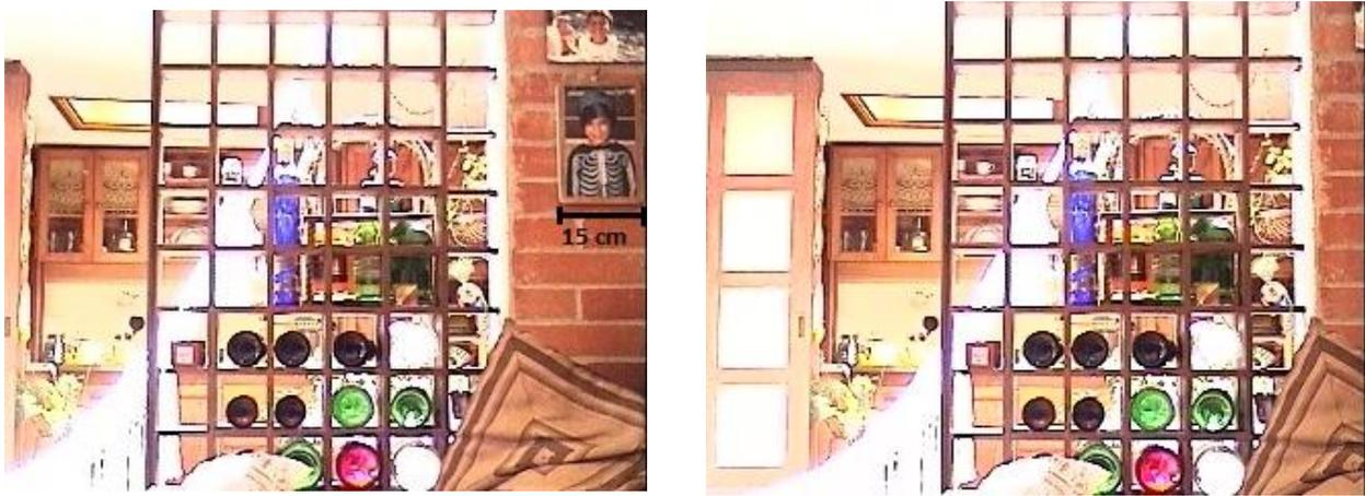
**Figura 60** Imágenes A y B para encontrar la homografía correspondiente. La primera imagen se ajusta para que coincida el borde de la imagen capturada con el punto de origen de los 15cm. La segunda imagen se captura cuando el borde derecho de la imagen llega al punto final de los 15cm.
