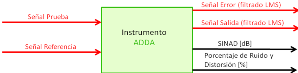
Figura 8: Diagrama General del funcionamiento Instrumento ADDA
