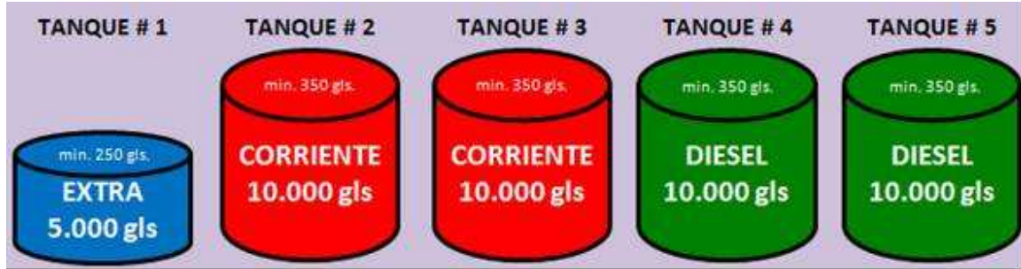
Imagen No.3. Implementación de productos, tanques y capacidad de tanques E/S San Cristóbal.
