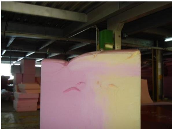
Ilustración 12. Defectos en los bloques de espuma III.
