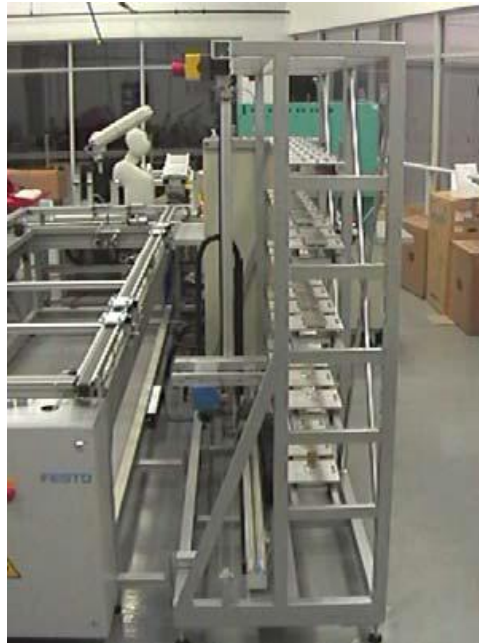
Figura 3. Almacén Materia prima y producto terminado
