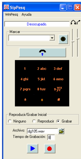
FIGURA 46 Teléfono IP con el nombre del archivo en el que se va a grabar
