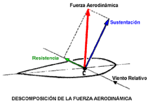
Figura 4. Descomposición de la fuerza aerodinámica
