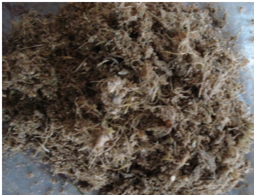
Figura 7.6. Mezcla de tratamiento que formo apelmazamientos.
