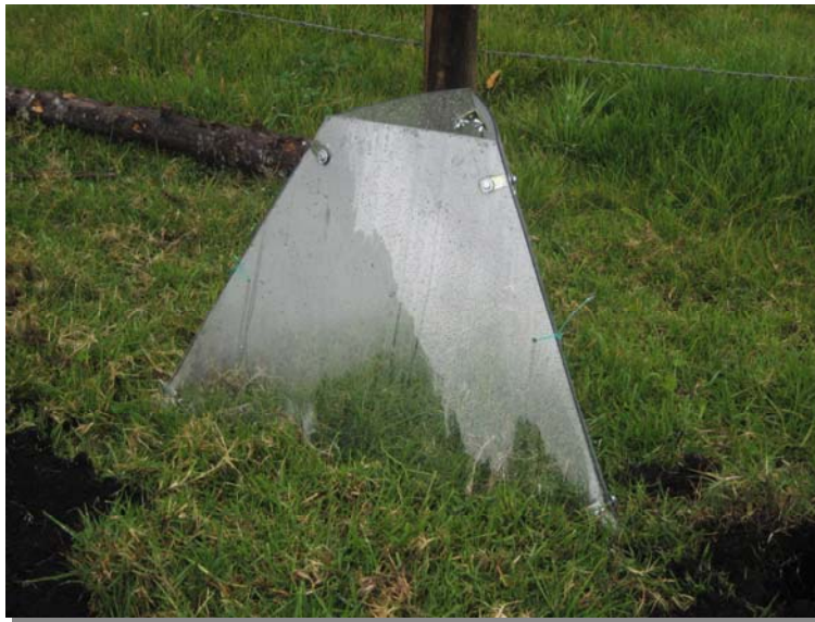
Figura 3: Dispositivo utilizado para aumentar la temperatura del suelo. Pirámide de Policarbonato en pastizal para ganadería de la vereda San José. Mundo Nuevo.
