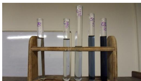
Figura 10. Prueba de residualidad del desinfectante: Resultados de la reacción colorimétrica con reactivo de Follin Ciocalteau y carbonato de sodio al 20% de los extractos de Semilla y Cáscara de uva Isabella a 5ppm y 10ppm para cuantificación de taninos.
