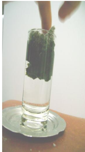
PRODUCTO “ADSORBENTE NOW” DESPUÉS DE ABSORBER EL ACPM
