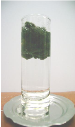
PRODUCTO “ADSORBENTE NOW” DESPUÉS DE ABSORBER EL ACPM
