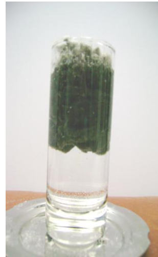
PRODUCTO “ADSORBENTE NOW” DESPUÉS DE ABSORBER EL ACPM
