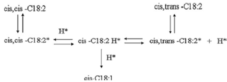
Figura 23. Hidrogenación del ácido linoleico (C18:2) a ácido oleico (C18:1) (Singh et al. 2010).
