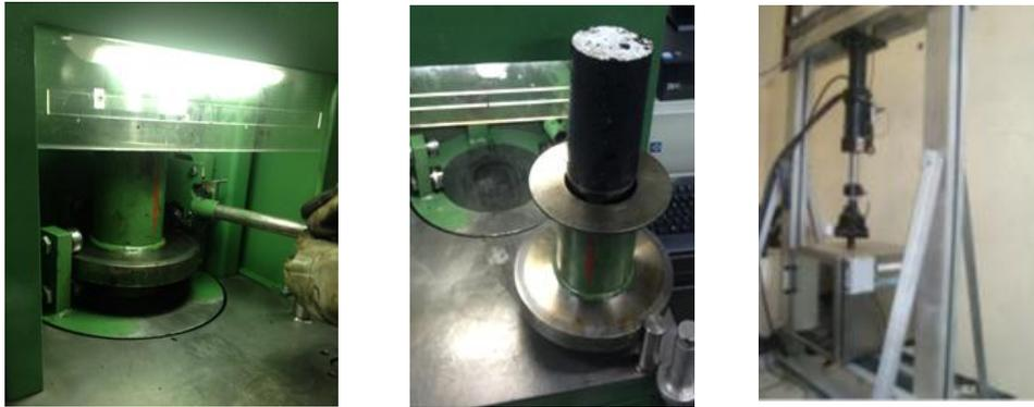
**Figura 4-6** a) Aplicación de ángulos b) Cilindro de mezcla asfáltica modificada, para modulo dinamico; c) MTS.
