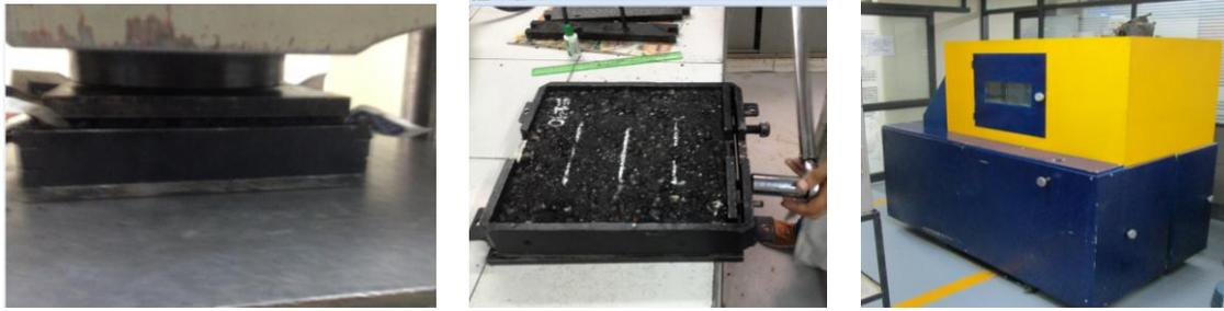
**Figura 4-5** briqueta de la mezcla asfáltica modificada a) compactación en la maquina universal; b) preparación de la briqueta para insertar en la maquina ahuelladora; c) Maquina ahuelladora.
