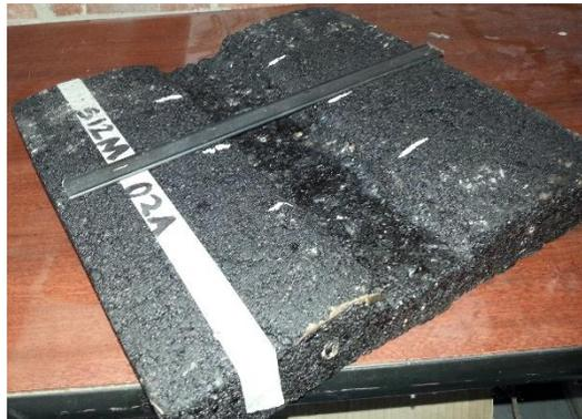
Figura 10. Probeta de ahuellamiento.
