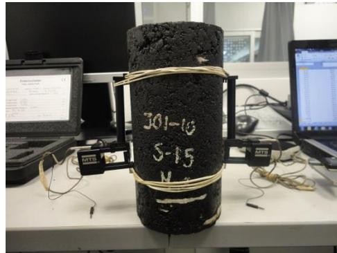
Figura 14. Probeta para módulo dinámico – PUJ
