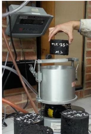
Figura 8. Saturación para el ensayo de TSR.
