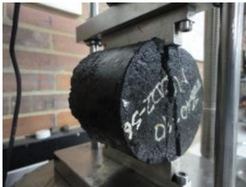
Figura 7. Probeta fallada en la prensa de carga para el ensayo de TSR y MIST.
