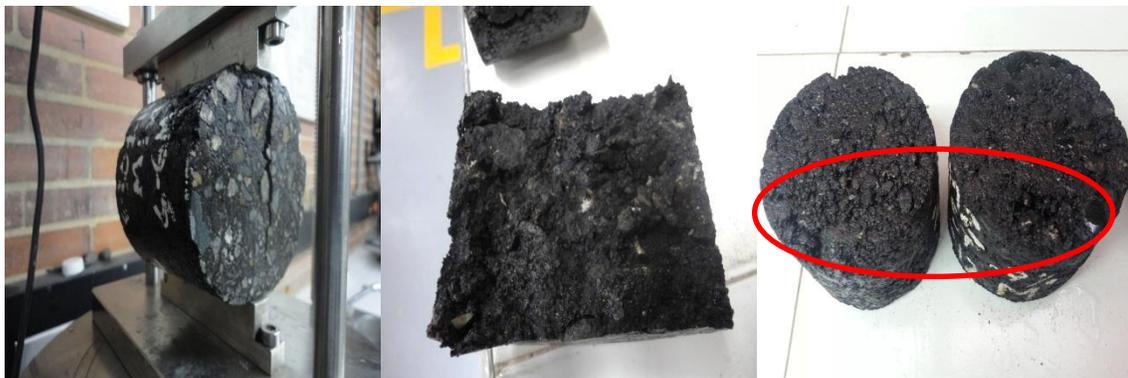
Figura 27. Desprendimiento de agregados en pruebas de daño por humedad.
