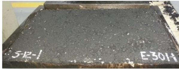
Figura 12. Molde para elaborar las probetas trapezoidales- PUJ
