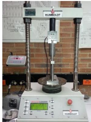
Figura 6. Prensa de carga que se empleó para el ensayo TSR y MIST.
