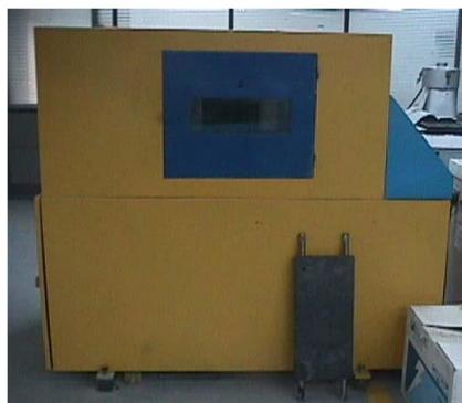
Figura 9. Equipo de ahuellamiento norma INVÍAS – PUJ.
