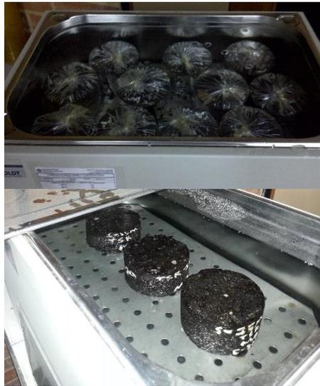
Figura 5. Condición seca y húmeda para el ensayo MIST.
