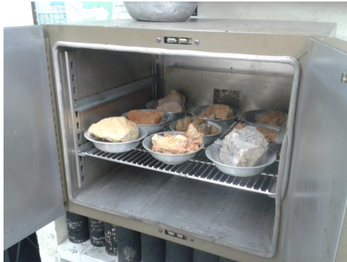
Figura 3-17 Pruebas de humedad en laboratorio
