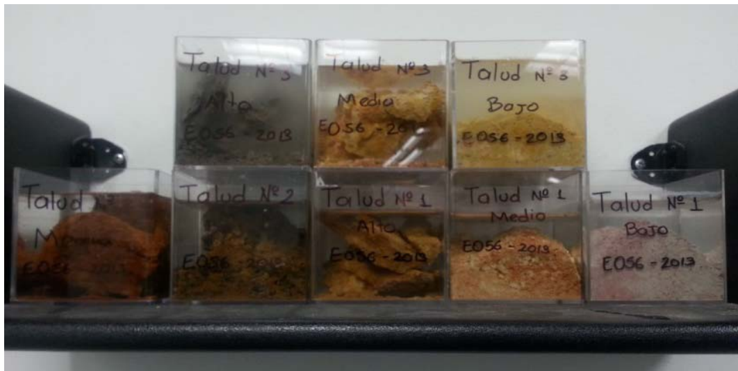
Figura 3-16 Jar Slake en muestras de rocas degradadas
