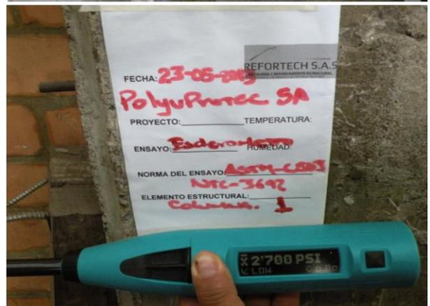
Se realizo prueba de esclerometro digital sobre columnas de la zona No 1, previamente calibrado el esclerometro con un frente de carbonatación mayor a 6 mm
