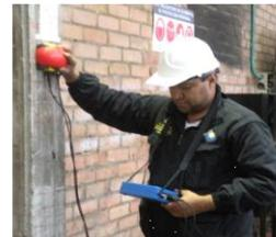
Figura 20. Ensayo de esclerometria del concreto – fase muestreo y material de prueba. Zona 1 de la bodega caso de estudio.
