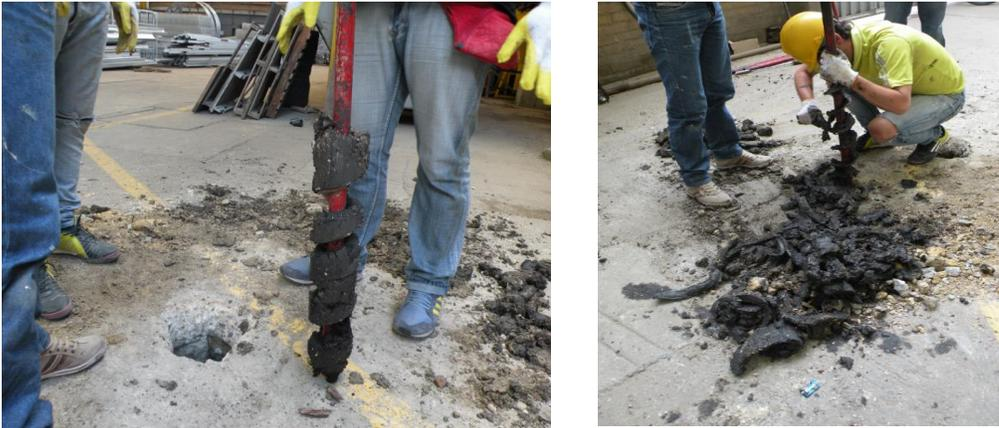
*Figura 40. Localización de apiques para la verificación de la cimentación superficial a 1.20 metros de profundidad.*
