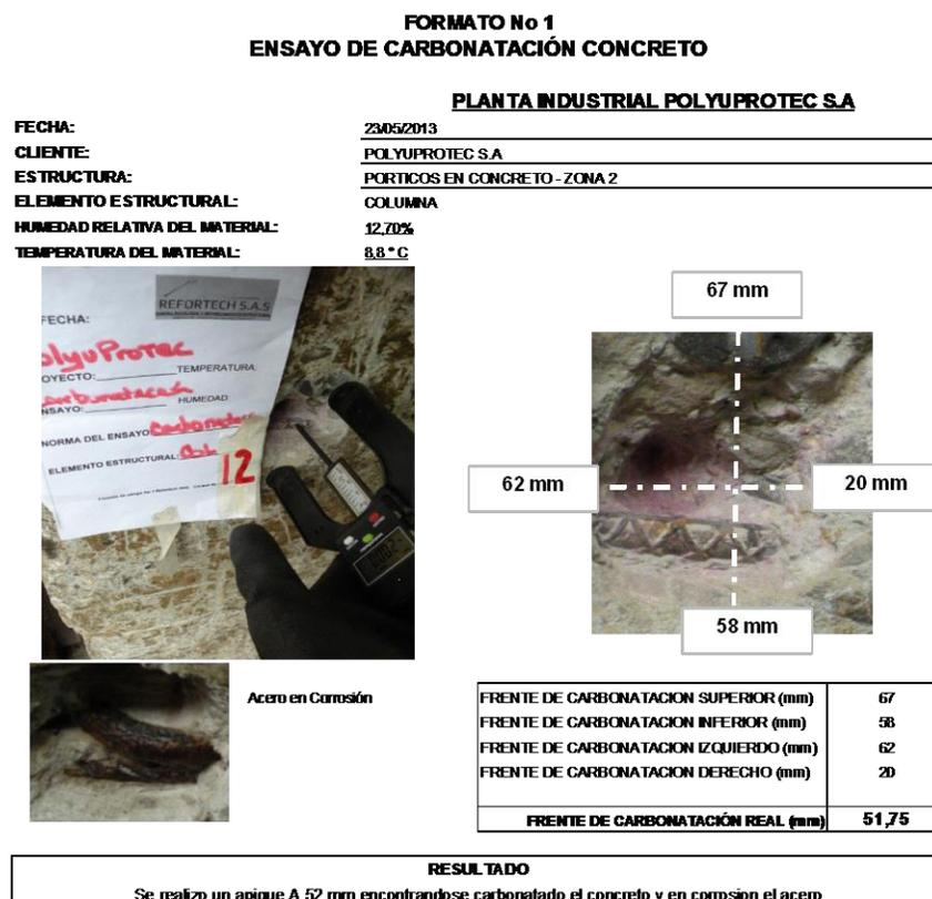
Figura 23. Ensayo carbonatación del concreto – fase muestreo y material de prueba. zona 1 de la bodega caso de estudio
