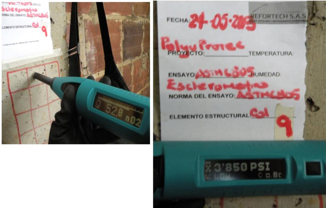
Se realizó prueba de esclerometro digital sobre columnas de la zona No 2, previamente calibrado el esclerometro con un frente de carbonatación mayor a 6 mm
