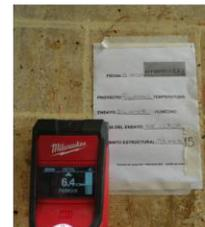
*Figura 25. Ensayo de escáner del concreto – fase muestreo y material de prueba. Zona 2 de la bodega caso de estudio.*
