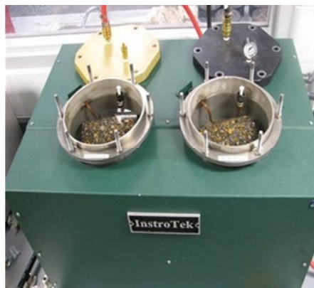
Figura 17. Especímenes acondicionamiento húmedo Fuente: (Guía de operación Equipo MIST InstroTek, Inc.)
