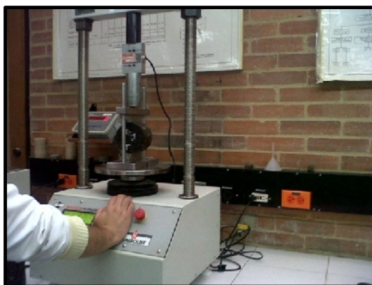
Figura 18. Ensayo Tracción indirecta Fuente: (Presentación propia de los autores)
