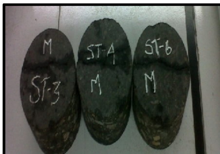
Figura 16. Especímenes acondicionamiento seco. Fuente: (Presentación propia de los autores)
