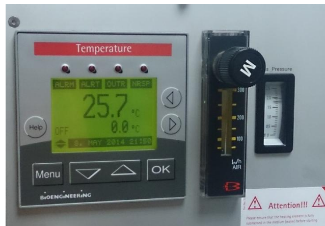
Figura 5. Display controlador de temperatura.
