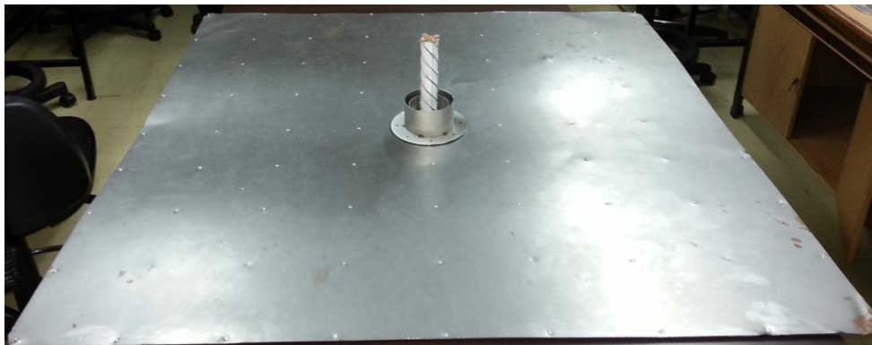
Figura 64 Vista total de la implementación de la antena con mangas No 2
