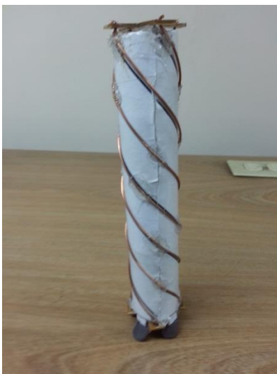
Figura 55 Antena Helicoidal Cuadrifilar
