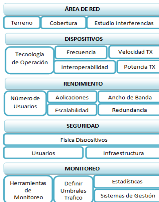
Figura 1. Aspectos principales a considerar en un diseño de red. Fuente: Elaboración propia basado en [11][12].
