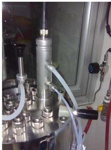
Fig 59. Sonda de pervaporación instalada en el biorreactor
