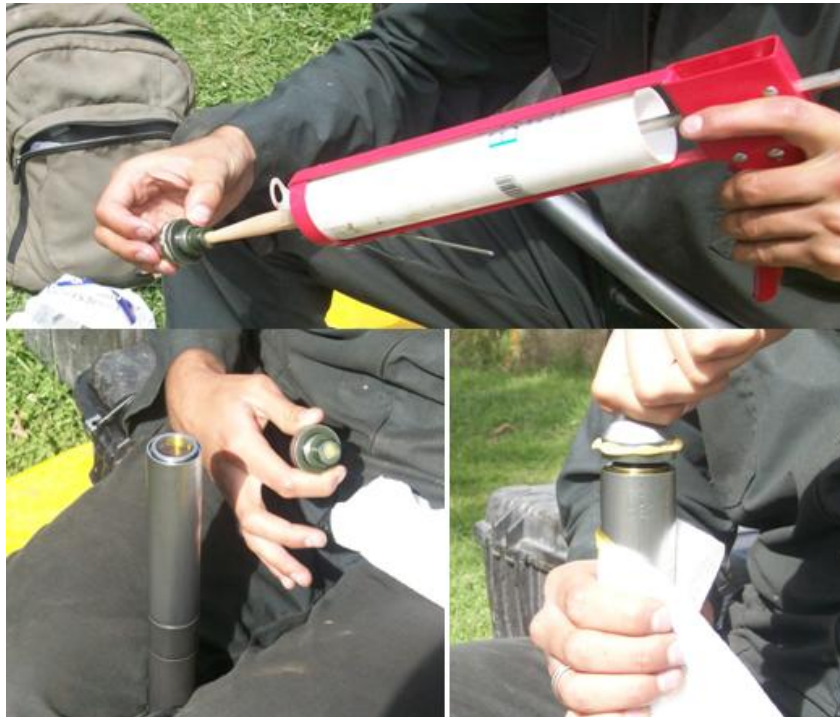
Figura 14. Preparación del cono para mediciones de presión de poros dentro del piezocono.
