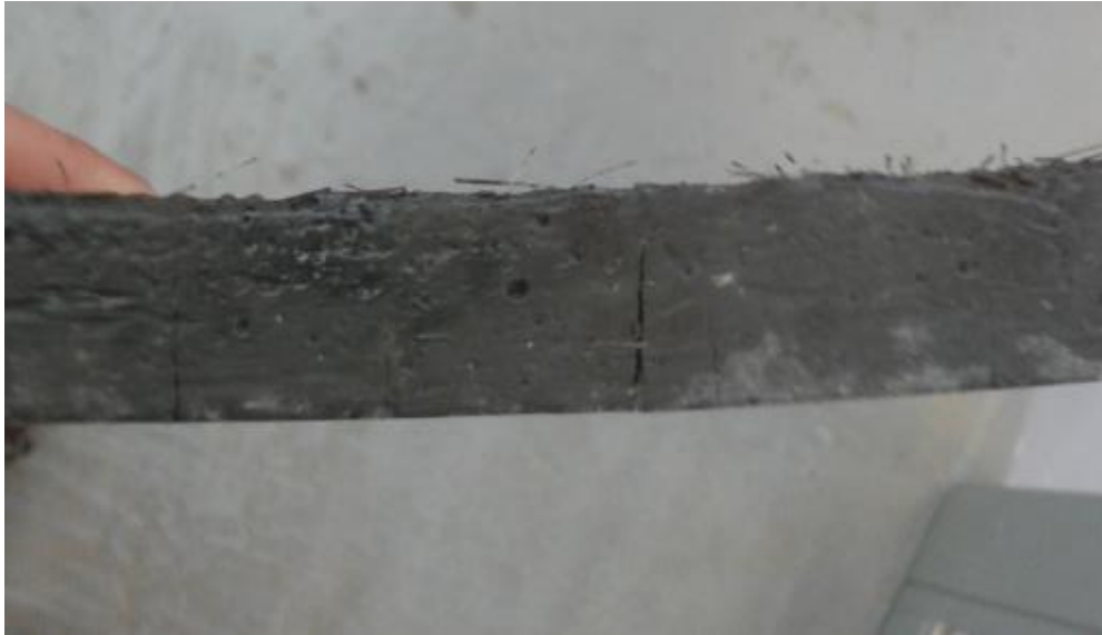
Imagen 16. Falla de probetas con PVA 20mm
