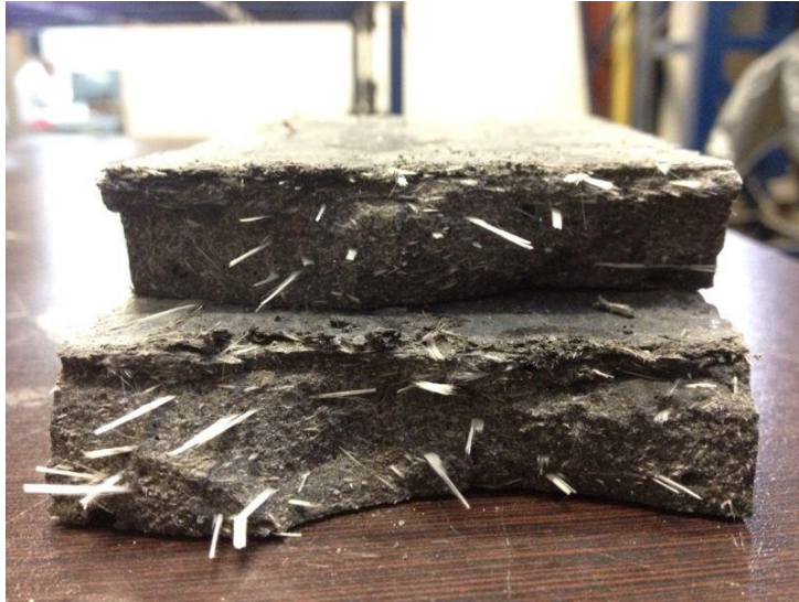
Imagen 14. Falla probeta con fibras de FG-36mm y FG-12mm
