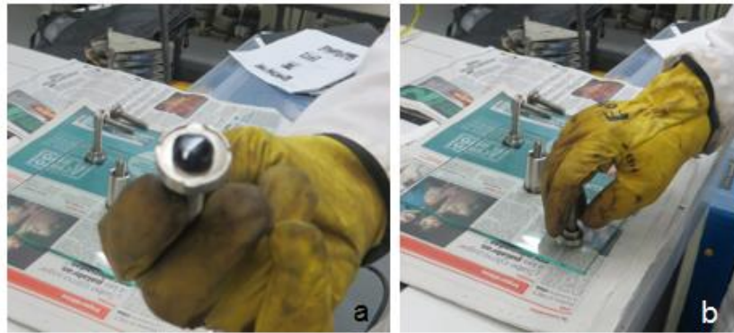
Figura 15 (a) Tornillo con gota de asfalto y (b) Montaje del tornillo con asfalto sobre la superficie. Fuente: Propia, 2014.
