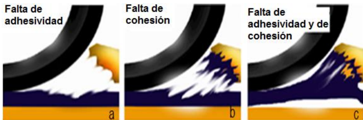
Figura 3 Falta adhesiva y cohesiva en la interacción asfalto agregado Fuente: Gutiérrez-Muñiz, 2008
