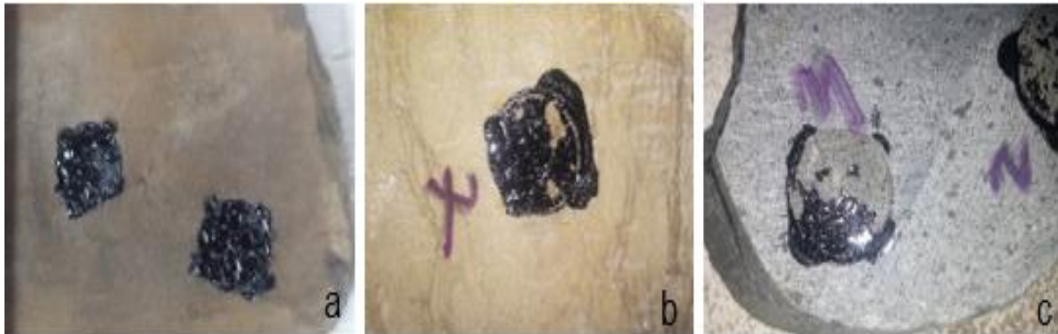
Figura 30 Comportamiento de la Unión Asfalto-agregado en Condición Húmeda. Fuente: Propia, 2014.
