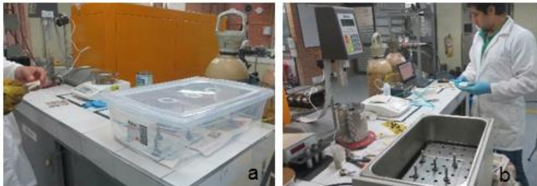
Figura 16 (a) Condición seca en un contenedor por 24 horas y (b) Condición húmeda en baño maría por 96 horas. Fuente: Propia, 2014.
