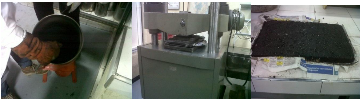
Figura 4-2 Mezclado, compactación y desmoldado de muestras para ensayos de fatiga
