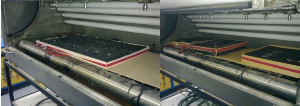
Figura 4-4 Disposición de muestras para fatiga y ahuellamiento en la cámara UV.
