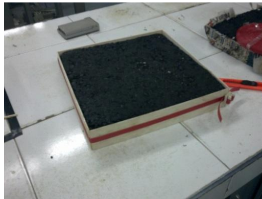
Figura 4-3 Muestra preparada antes de su ingreso a la cámara UV.
