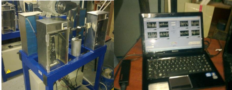
Figura 4-5 Bancos de fatiga utilizados en la investigación
