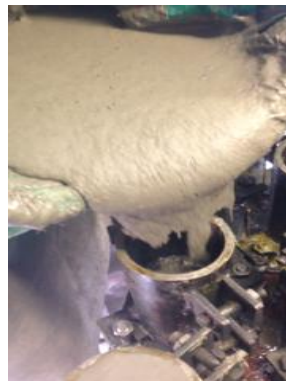
Figura 16. Disposición de la mezcla en moldes
