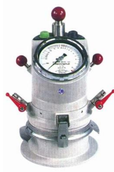
Figura 8. Medidor para determinar el contenido de aire del concreto fresco
