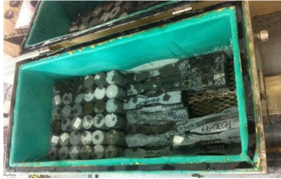
Figura 10. Cámara de vapor
