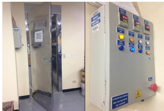
Figura 9. Cámara de laboratorio y controladores de temperatura y humedad
