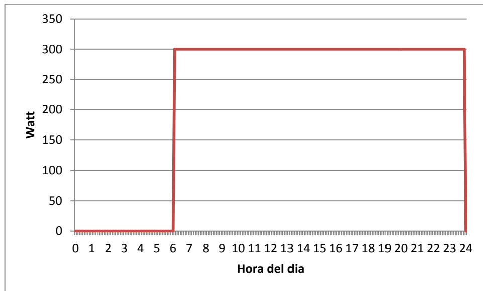
Figura 10. Demanda Servicio Eléctrico
