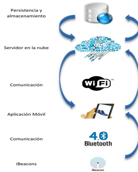
Figura 2. Esquema Funcional Smart Shoppers
