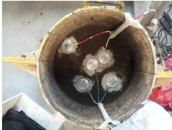
Imagen 6 Configuración de ubicación de celdas de carga.
