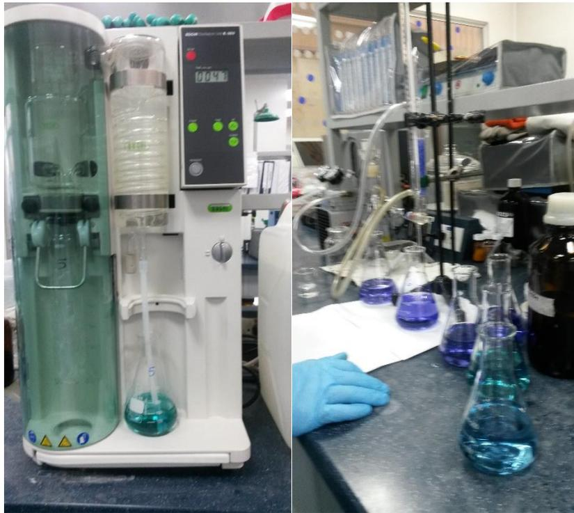
**Figura 8: Ensayo de nitrógeno amoniacal.**
