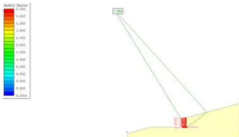
FIGURA 4.144 MURO PANTALLA CON ESFUERZOS AUMENTADOS AL 150%
