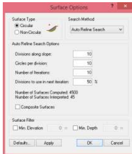
FIGURA 3.69 SUPERFICIES DE FALLA
