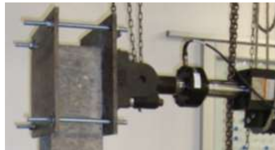
Figura 40. Aditamento para sujetar la viga al actuador hidráulico.
