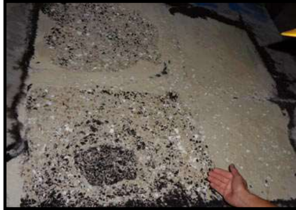
Figura 6. Sika S.A Informaciones Técnicas, Concreto reforzado. Prueba de resistencia al fuego de paneles de concreto reforzado con fibras
