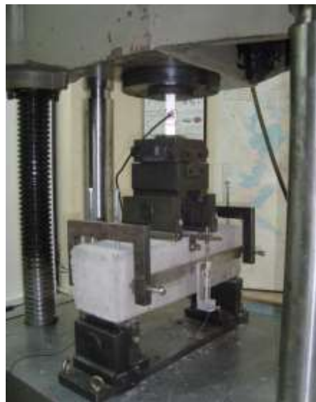
Figura 45. Montaje del ensayo de resistencia flexural.
