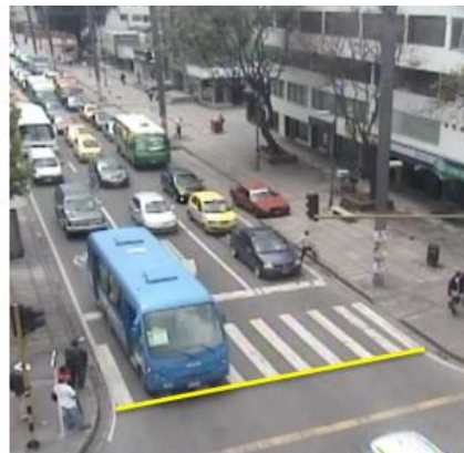
Figura 3. Identificación de línea de control para captura automática de vehículos
