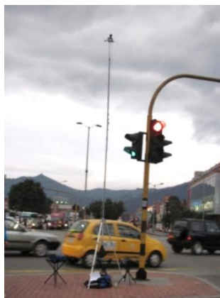
Figura 15 . Montaje del trípode y la cámara de video.
