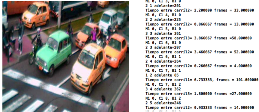
Figura 18. Procesamiento de videos con el software de visión artificial para intervalos de paso entre vehículos.
