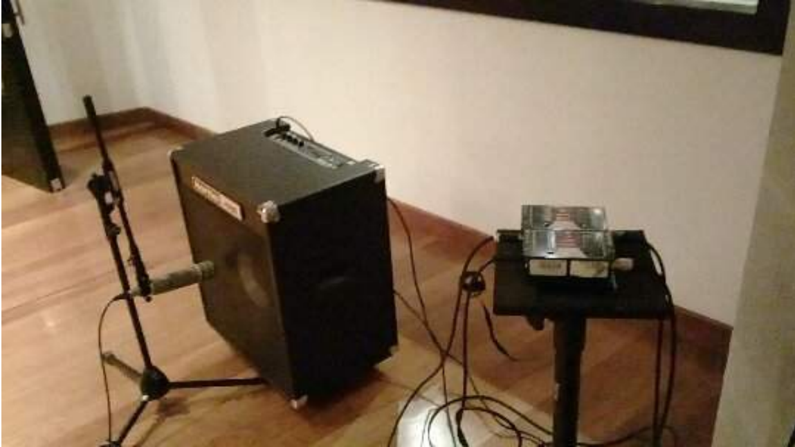
Imagen 10: Documentación fotográfica del reamping realizado con el amplificador Hardtke HD 150 y una caja directa Radia Engineering JDI.
