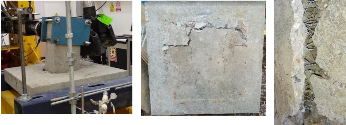
Figura 62. Fotos de la falla primer modelo.
