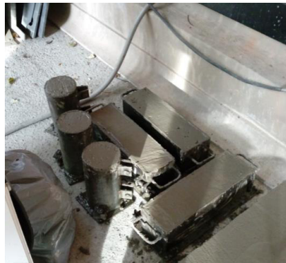
Figura 44. Vigas y cilindros.
