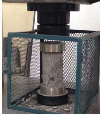
Figura 51. Falla cilindro concreto con fibra.
