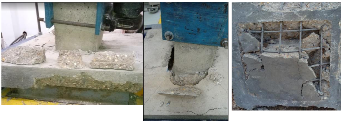
Figura 73. Fotos de la falla cuarto modelo sin fibras.
