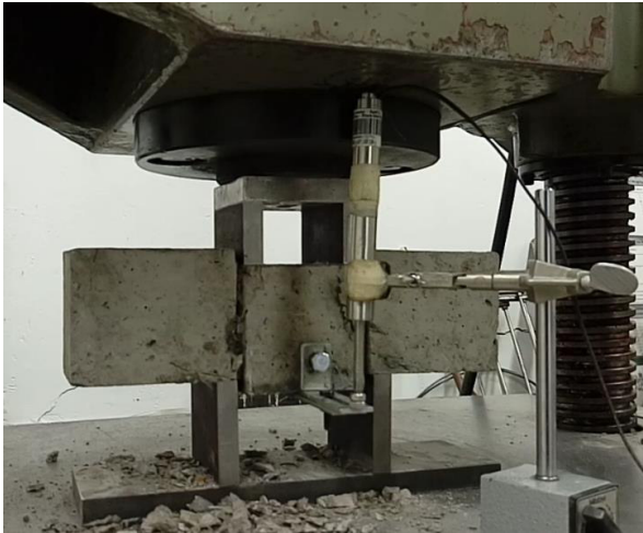
Figura 55. Modo de falla a corte viga con fibra.
