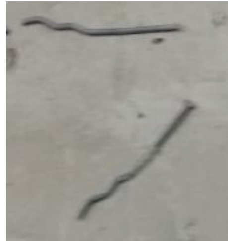
Figura 56. Modo de falla fibras.
