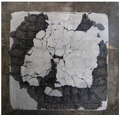
(Concreto sin fibras)
