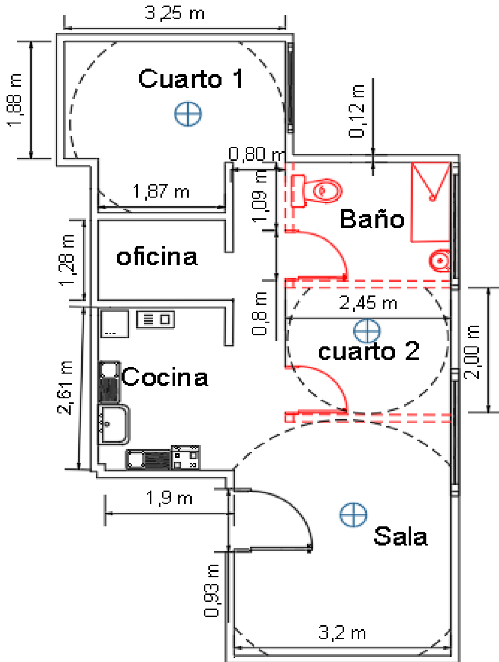
Figura 7.3. Alcance sensor de temperatura y humedad
