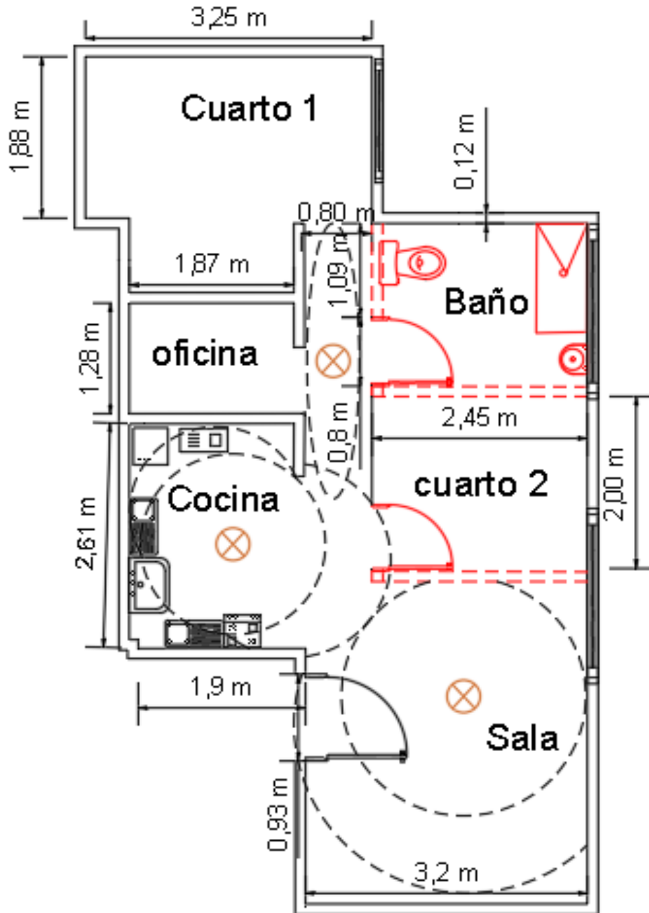
Figura 7.4. Alcance detector de monóxido de carbono
