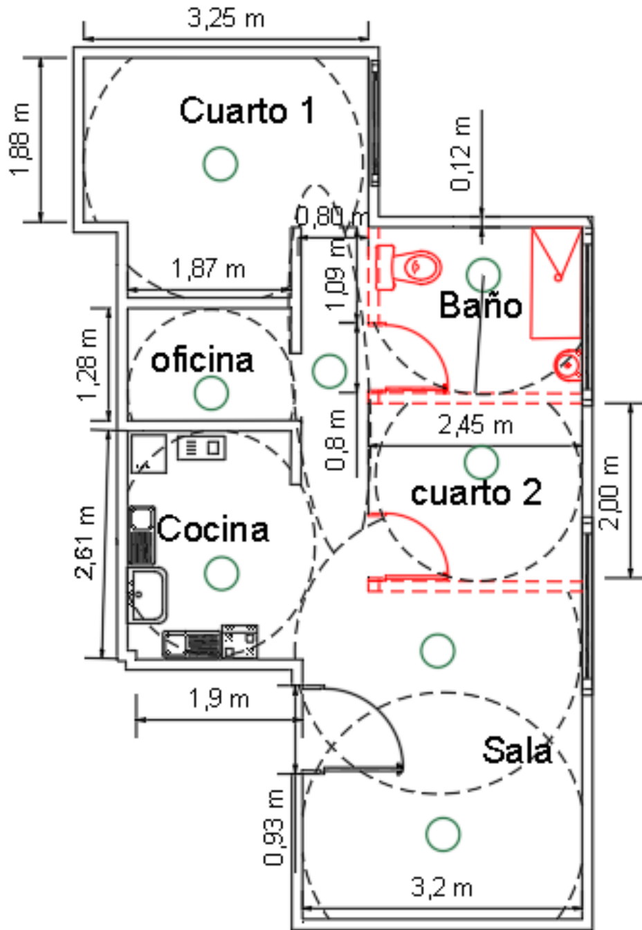
Figura 7.1. Rangos de alcance sensor de movimiento
