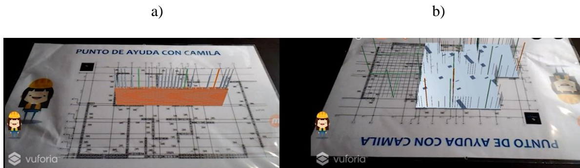
Figura 6. Modelos elementos 3D a) muro en mampostería y b) placa en concreto.
