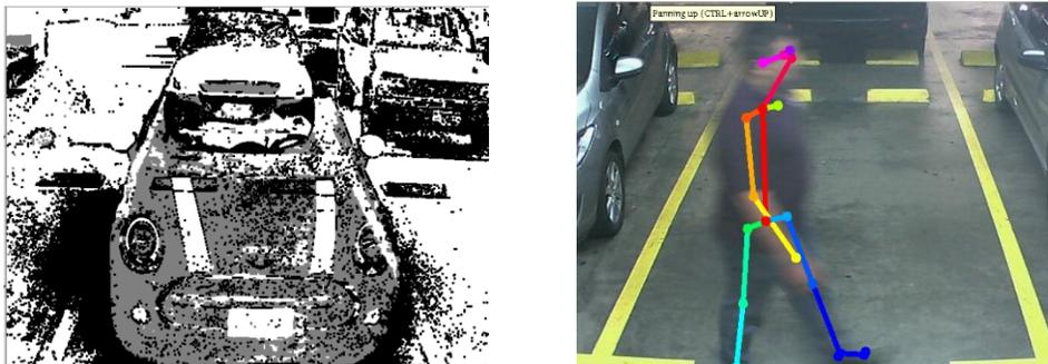
**Figura 9: A: Imagen resultante de aplicar el algoritmo de extracción de fondo KNN en un vehículo en proceso de parqueo. B: Resultados de aplicar la librería OpenPose sobre una de las imágenes pertenecientes a las secuencias de video capturadas.**
