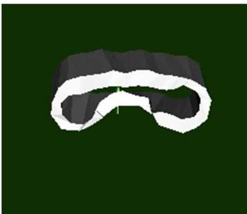
Figura 31. Choque del cilindro contra el plano deformándose.
