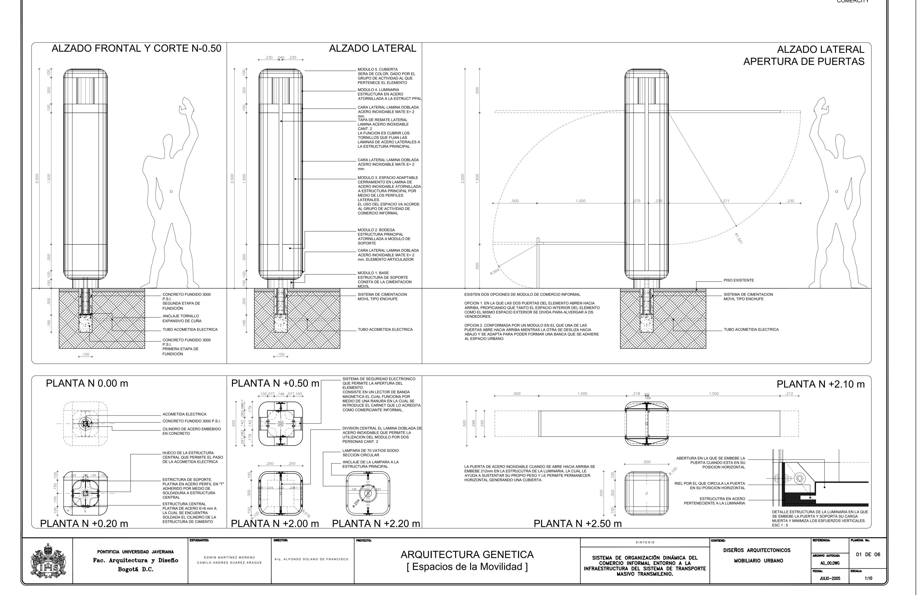
NOTA 1: EL CORTE QUE SE HAGA EN EL PISO EXISTENTE PARA EMBEBER EL ELEMENTO SE DEBE HACER CON CORTADORA DE DISCO Y DEBE SER DE FORMA CIRCULAR. EL ACABADO DE PISO DEL AREA AFECTADA DEBE SER UNA VARIACION DE LA BALDOSA DE 40x40cms PARA CONTINUAR CON LAS TEXTURAS O ENTRAMADOS EXISTENTES.
