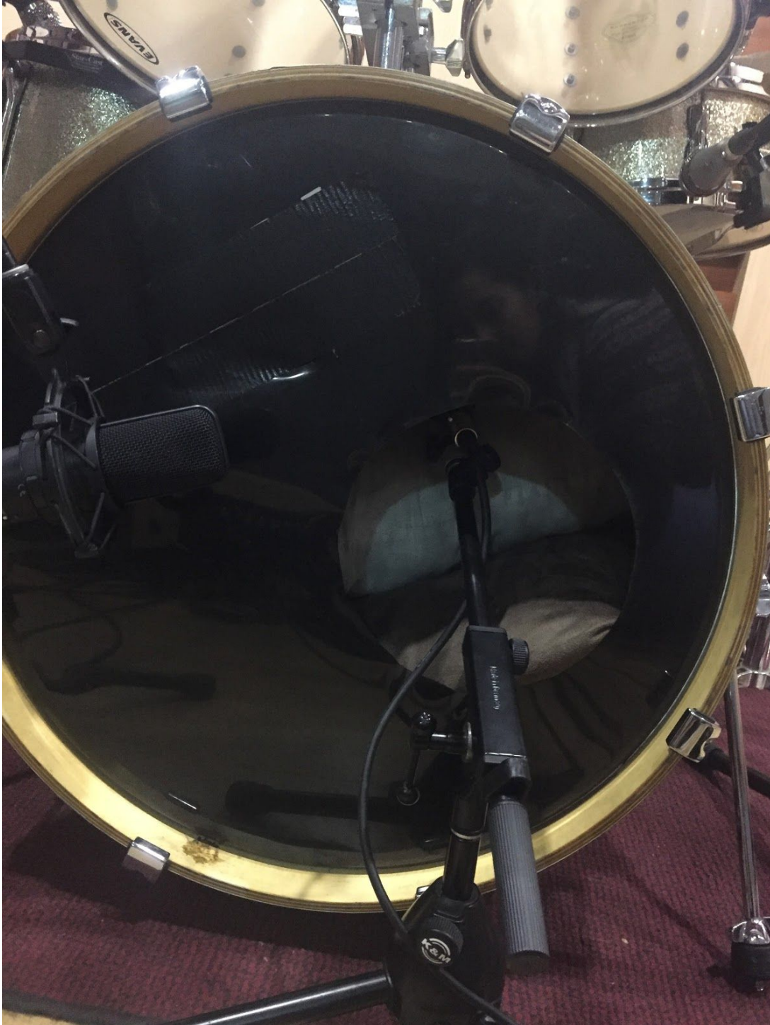
Imagen No. 3: Ubicación de los micrófonos Audio-Technica AT4050 y Audix D6 en el bombo.
