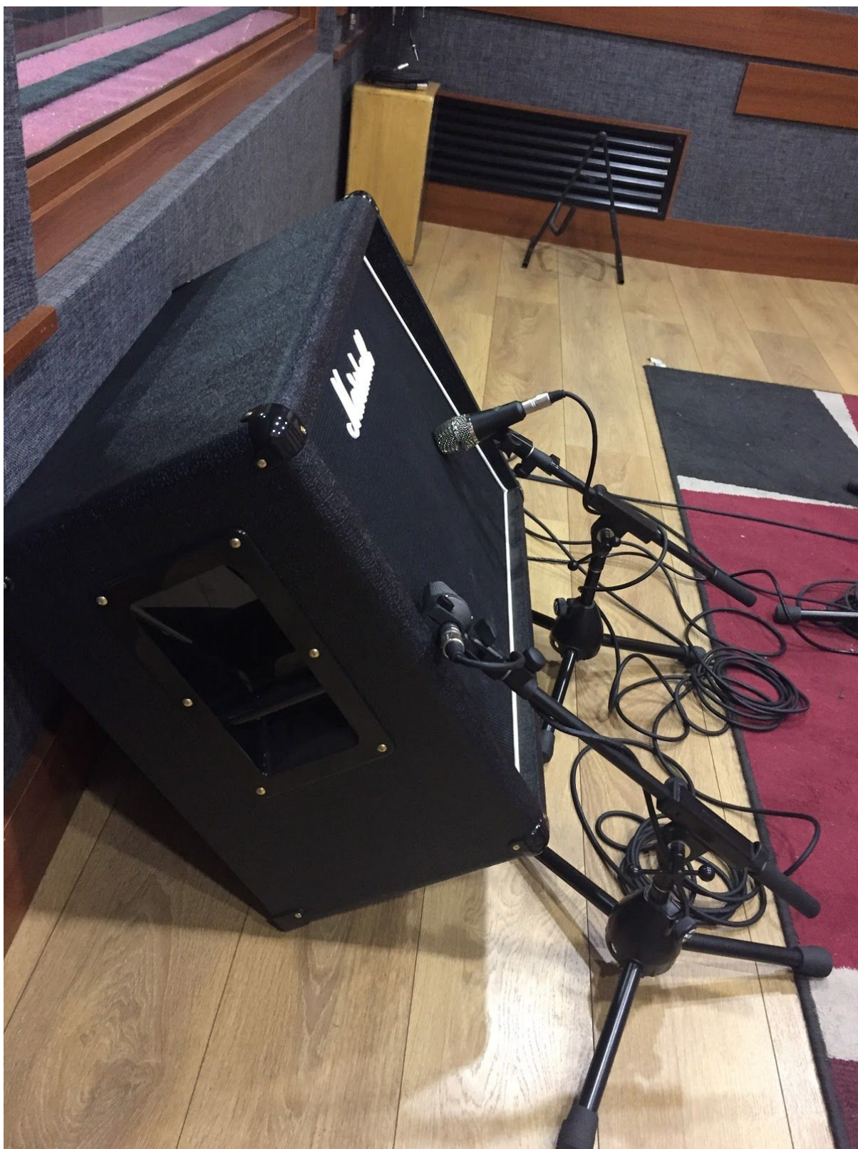
Imagen No. 6: Ubicación de los micrófonos en el amplificador Marshall MX212
